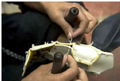
Das Zusammennähen der fünfeckigen Panels wird von Hand erledigt. Zunächst werden sie „auf links“ zusammengenäht. Die letzten Stiche erfordern großes handwerkliches Geschick, weil die Naht unsichtbar bleiben muss.
